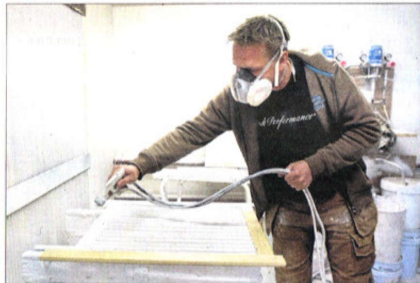
Radiatorskjulernerne skal have et lidt tyktflydende lag maling, for det giver i sidste ende et mere autentisk look, som om skjulerner har været en del af rummet, siden huset blev bygget.
